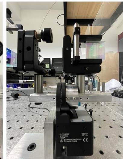
移動光柵系統模擬不同疊層對準大小
